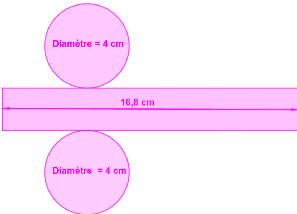
S'il s'agit du patron d'un cylindre de révolution, la longueur du rectangle doit être égale au périmètre de la base cylindrique.
